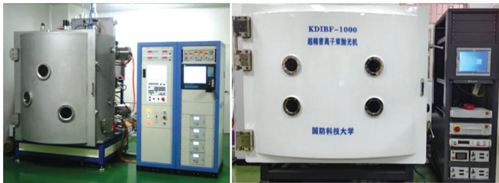
图 9 国防科技大学研制的离子束抛光机床
