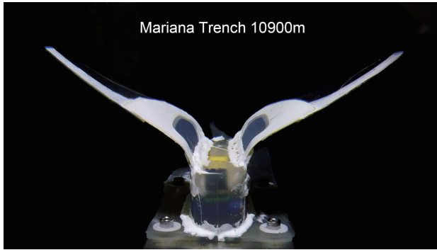
图9 软机器人在马里亚纳海沟万米深海驱动实验
